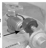
(C) Maintenir l'écrou de raccordement et l'adaptateur comme illustré pour effectuer un raccordement correct avec le robinet de la bouteille de GPL.
