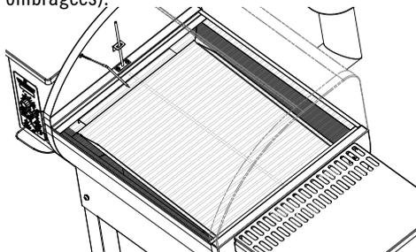
La chaleur directe endommagera le fil de la sonde et annulera la garantie. Toujours diriger la sonde de viande par le côté du grill. Ne pas plonger le fil dans l'eau. Ne convient pas au lave-vaisselle.
