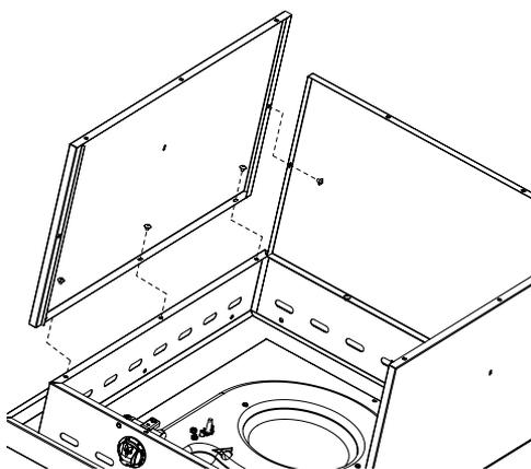
Monter la cloison centrale à l'aide de 2 vis #10 comme illustré. Ne pas serrer les vis à fond à ce stade.
