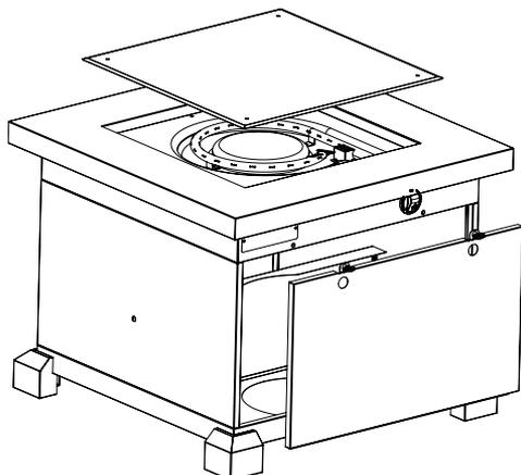
Installez les vis à oreilles 1/4-20 à la porte et fixer en place avec les écrous 1/4 de pousoirs comme indiqué. Veillez à insérer les vis à oreilles de l'extérieur, comme illustré. Les noix de poussée sont pressées sur les filets de la vis de serrage pour tenir en place.
